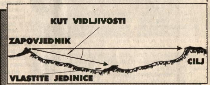
Sl. 3 – Provjera mogućnosti gađanja preko vlastitih jedinica mjerenjem kuta vidljivosti
