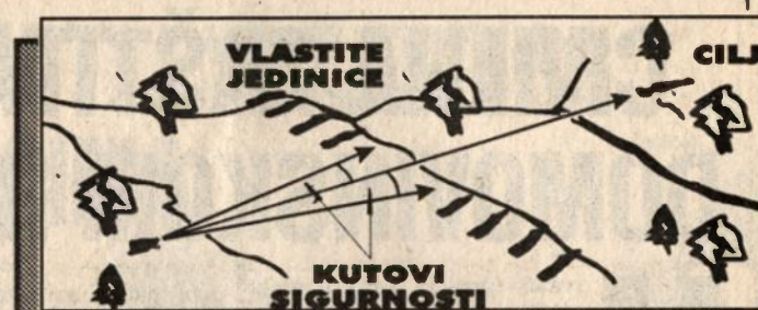
Sl. 2 – kutovi sigurnosti pri gađanju kroz međuprostor utvrđenim mitraljezom
